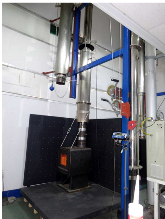
Figura 2 – Ensayo de calefactor a leña
