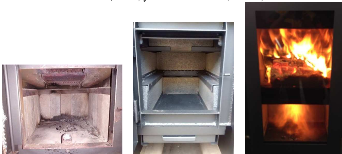
Figura 6 - Cámara de combustión calefactores a leña antiguo (izquierda), nuevo (centro) y de llama invertida (derecha)
