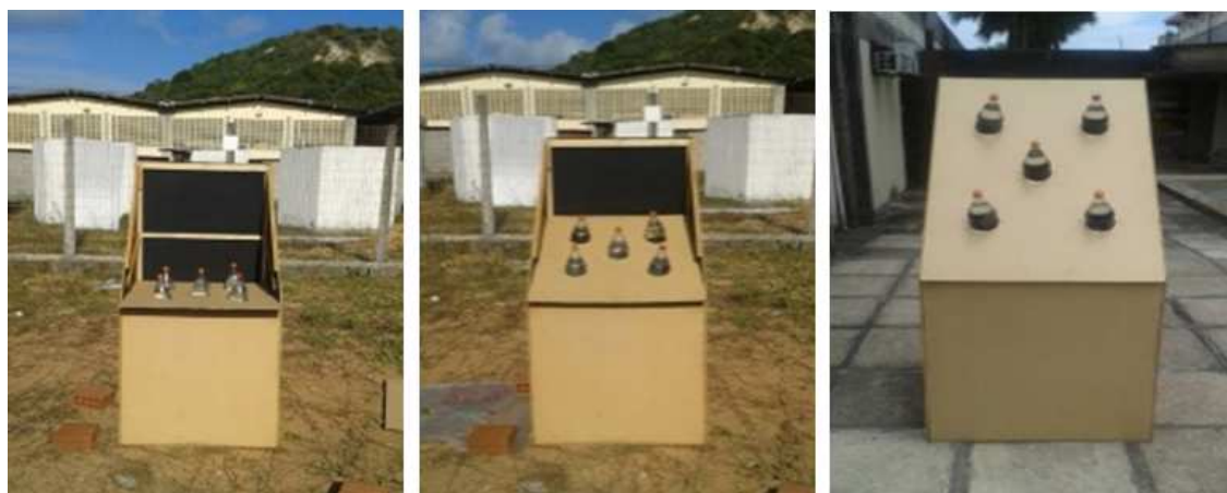
Figura 4 – Câmara experimental exposta ao sol com as respectivas inclinações de 0°, 22,5° e 45°.
