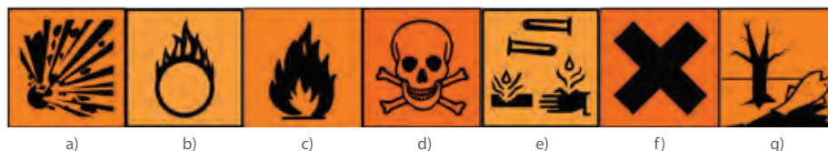
Figura n.º 1 - Símbolos e indicações de perigo das substâncias e misturas perigosas. a) Explosivo; b) Comburente; c) Inflamável; d) Tóxico; e) Corrosivo; f) Nocivo; g) Perigoso para o ambiente
